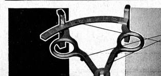
Cet instrument de mesurage se come de 2 pièces en Fonte injectée peuvent être montées sans usina L'échelle est coulée directement
