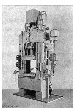
Presse hydraulique rapide d'une capacité de 25 à 125 tonnes.
