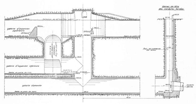
Fig. 2. — Chambre d'équilibre transformée (solution proposée).
