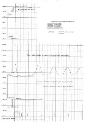
Fig. 10. — Chambre d'équilibre primitive (voir fig. 1). Le régulateur a tendance à entretenir l'oscillation. Il y a instabilité de réglage manifeste.
