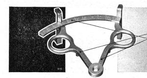
Cet instrument de mesurage se compose de 2 pièces en Fonte injectée qui peuvent être montées sans usinage. L'échelle est coulée directement.
