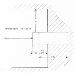
Fig. 7. — Schéma de plate-forme de plongeoir.
