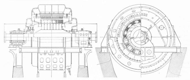
Fig. 4. — Coupe d'un alternateur de 37 500 kVA, 13 000 V, 500 t : min., de la centrale de Chandoline.
