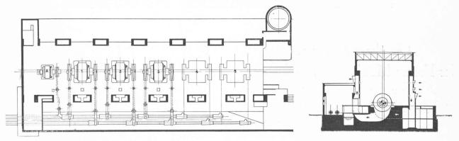
Fig. 3. — Plans et coupe de la centrale de Chandoline.
