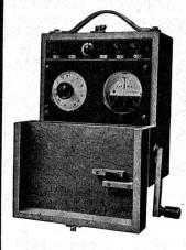
Appareil pour la mesure des prises de terre.
