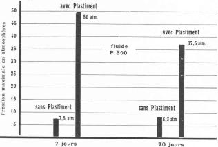
Fig. 1. Essais de perméabilité.
