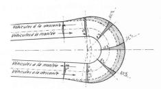
Tournant à droite (montée à l'intérieur) suivant les nouvelles propositions.
