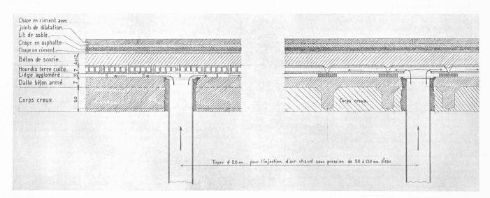
Fig. 1. — Coupe de la dalle de couverture et ajustement d'un tuyau d'injection d'air.
