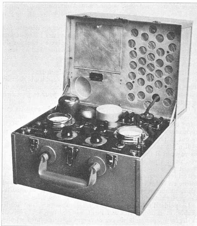
Fig. 2. — Amplificateur à lampes, pour « témoins sonores ».
