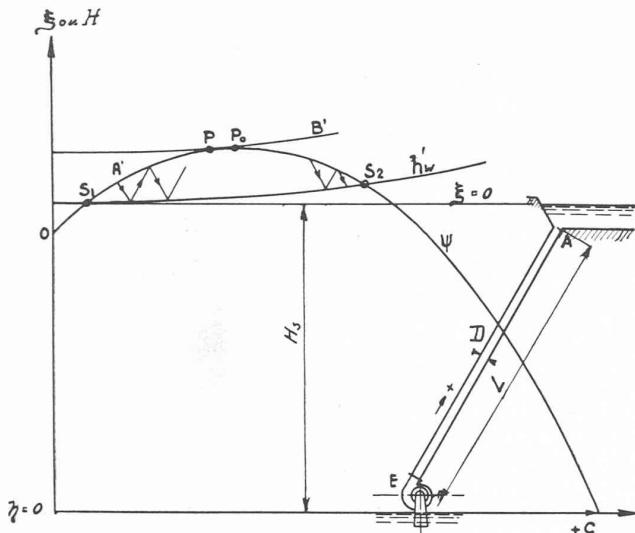
Fig. 1. — Conduite avec une caractéristique d'extrémité instable.
