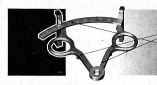
Cet instrument de mesurage se compose de 2 pièces en Fonte injectée qui peuvent être montées sans usinage. L'échelle est coulée directement.
