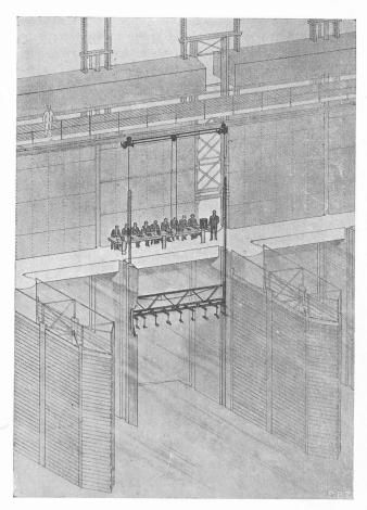
Fig. 6. — Dispositif réalisé pour les jaugeages du débit des turbines à Chancy-Pougny. Cliché Schweizerische Beauzeitung.
