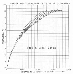
Fig. 9. — Rendemeut de la turbine 3, en fonction de la puissance sur l'arbre de la turbine.
