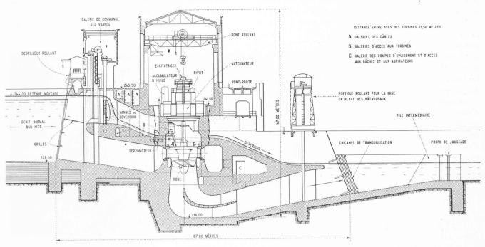
Fig. 1. - Coupe de l'usine de Kembs par un groupe.
