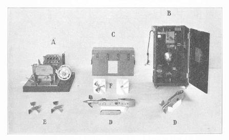
$\begin{array}{c} {\rm Fig.} \ 7. \ \_Appareils \ de \ mesure \ pour \ jaugeages. \\ A = {\rm enregistreur} \ ; \ B = {\rm pendule} \ {\rm \'electrique} \ ; \ C = {\rm batterie} \ ; \ D = {\rm moulinets} \ ; \\ E = {\rm h\'elices} \ de \ moulinets} \ ; \ F = {\rm moule} \ en \ {\rm pl\'atre}. \end{array}$
