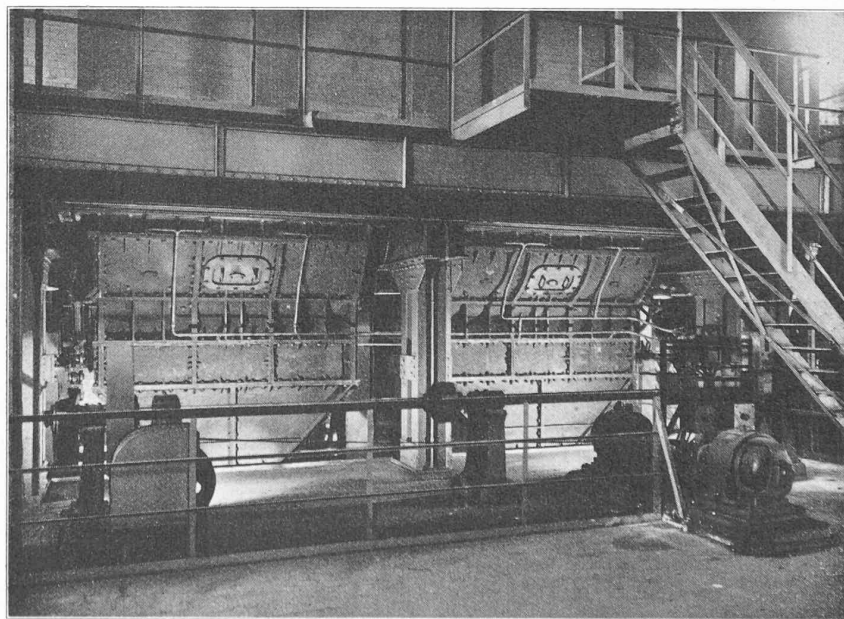
Fig. 4. — Fours Woodall-Duckham. Extraction du coke éteint.
