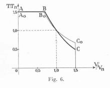
ristique d'un pareil moteur, équipé d'une résistance liquide. La droite AB se rapporte à cette résistance de fonc ionnement continu, suivant l'équation  $T:T_n=1,5$ . La courbe BC appartient au moteur même ; elle peut être approximativement représentée par l'équation :
