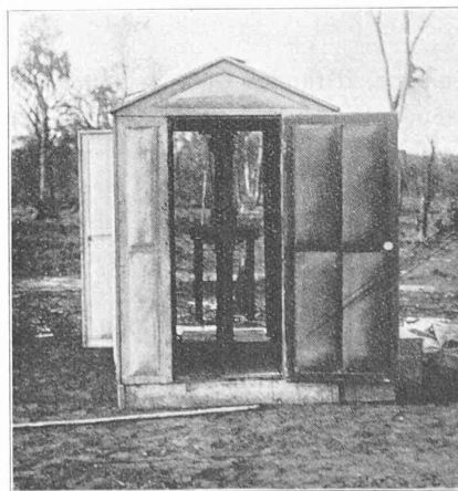
Fig. 4. — Balance de torsion grand modèle dans sa tente d'observation, sur une formation pétrolière au Venezuela.
