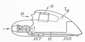
Fig. 6. — Chauffage système Jaray.
