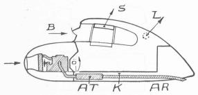
Fig. 6. — Chauffage système Jaray.
