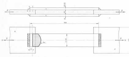
Fig. 1. — Mesure des dilatations longitudinales  $\delta x$  dans le plat b, à l'endroit s—s.
