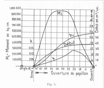
numériques pour un papillon de 3,20 m de diamètre, une pression h=25 m et un débit maximum admis de  $40~\rm{m^3/sec}$ .
