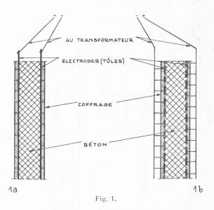
courant alternatif de faible tension, il est possible d'obtenir un chauffage économique sans installations compliquées; le béton offre une certaine résistance électrique et il se dégage de la chaleur. La perte de calories cédées au milieu ambiant est minime, car le coffrage forme une isolation calorifique avantageuse dans notre cas, où la source de chaleur est à l'intérieur du béton; par contre, cette isolation est un obstacle lorsque la chaleur vient de l'extérieur.
