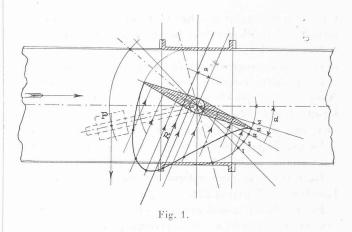
poussées sur la face amont du papillon vont en diminuant dans le sens du courant de l'eau, à cause de la vitesse croissante de la masse liquide.
