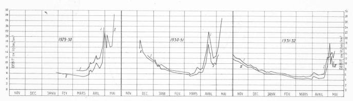
Fig. 3. — Débits spécifiques à différents niveaux dans l'Entremont
