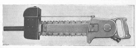
Fig. 5. - Scie à chaîne « Ado ».
