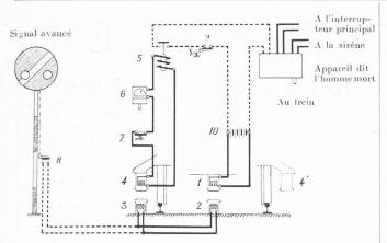
Fig. 1. — Schéma de l'appareil automatique de sécurité.
