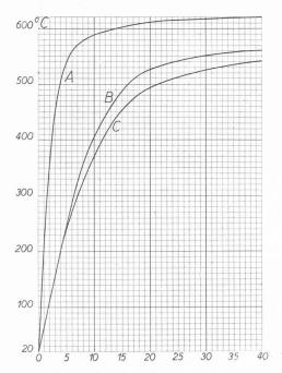
Comparaison de 3 plaques de cuisson. A = plaque ultra-rapide "Calorrex ". B, C = 2 plaques en fonte.
