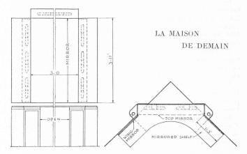
Fig. 11. — Coiffeuse surmontée d'une glace en tryptique. Les traits discontinus représentent le dispositif d'éclairage. Top mirror = glace centrale; Wing mirror = glace latérale; Mirrored shelf = table recouverte de glace.
