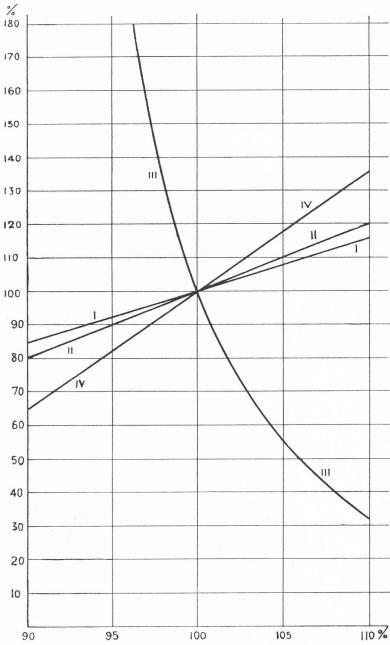
Fig. 3. — Eclairement, consommation et durée des lampes à incandescence, en fonction de la tension.
