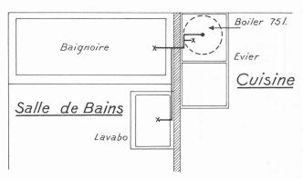
Fig. 11. — Trois postes d'eau chaude alimentés par un seul boiler.
