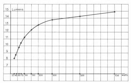
Fig. 2. — Efficacité lumineuse en fonction de la puissance des ampoules. (Lire Lumens/watt, au lieu de Lumens, sur l'axe des ordonnées.)
