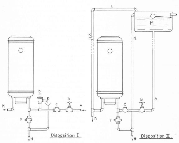
Fig. 10. — Agencement hydraulique des chauffe-eau.
