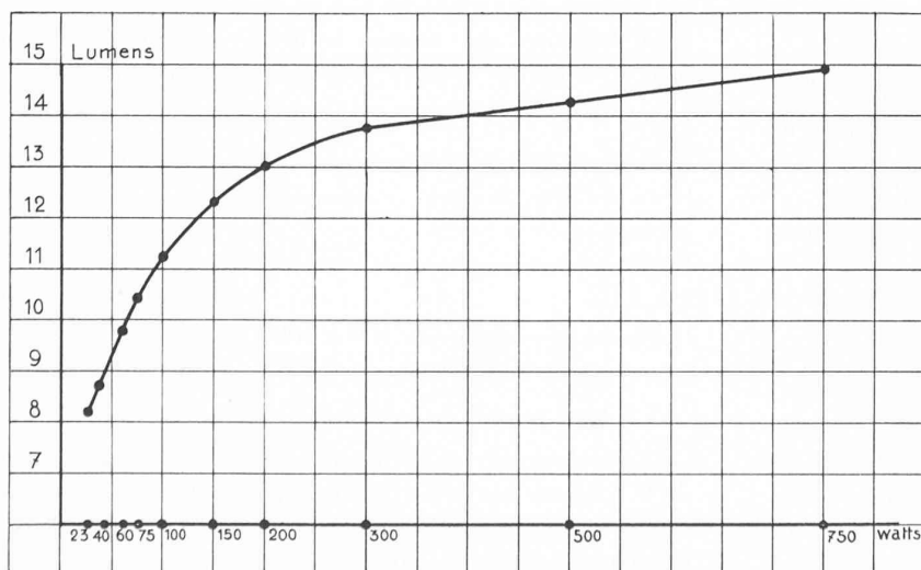
Fig. 2. — Efficacité lumineuse en fonction de la puissance des ampoules. (Lire Lumens/watt, au lieu de Lumens, sur l'axe des ordonnées.)
