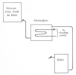
Fig. 12. — Schéma d'installation d'un réchauffeur.
