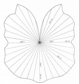
Fig. 1. — Courbe représentative des intensités lumineuses d'une lampe à filament en zig-zag.
