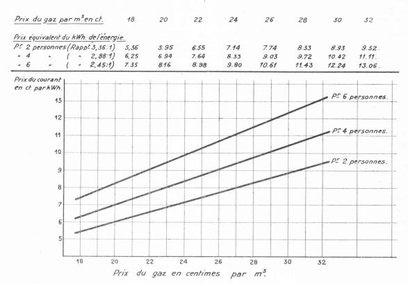
Fig. 14. — Comparaison entre le prix du gaz et celui de l'énergie électrique, en fonction de l'effectif des ménages.
