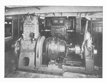
Fig. 8. — Groupe auxiliaire sur le « Genève ». Moteur Sulzer à 2 temps, 2 cylindres, 25 ch. eff., accouplé à une dynamo B. B. C. et à un compresseur Sulzer.
