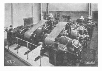
Fig. 3. — Commande des compresseurs d'ammoniaque par courroies trapézoïdales, en caoutchouc cordé.
