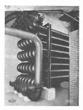
Fig. 4. — Condenseur d'ammoniaque Sulzer, à contre-courant.
