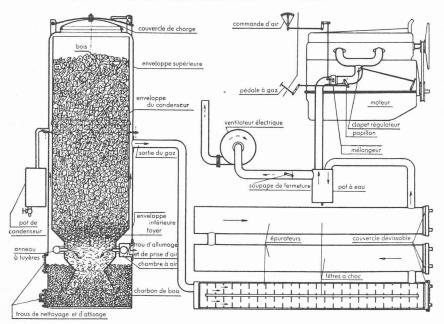
Fig. 2. — Principe du générateur Imbert.
