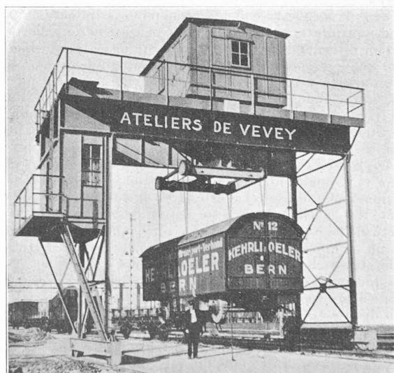
Le chariot roulant sur le portique est pourvu d'un treuil avec moteur de 36 ch et réducteur planétaire à 2 vitesses de levage.
