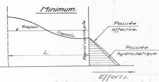
Fig. 5. — Poussées extrêmes agissant sur le parement extérieur d'une digue à parois verticales soumise au phénomène du clapotis.
