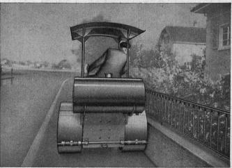
Rouleaux-moteur trijantes 3-5 tonnes, pour cylindrage de tapis, incorporation du gravillon, travaux de trottoirs.
