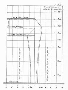
Fig. 1. — Poussées horizontales, maximum et minimum, agissant sur un mur vertical soumis à un clapotis de caractéristiques 2 L = 80 m, 4 h = 6 m. Résultats du calcul et de l'expérience.
