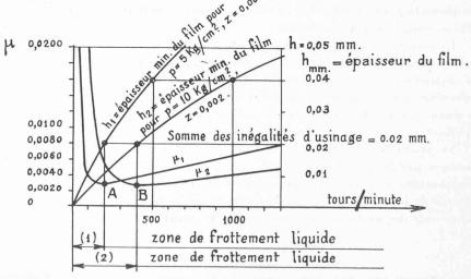
D'autre part, la résistance de frottement intérieur d'un lubrifiant trop visqueux, utilisé dans un coussinet remplissant toutes les conditions mécaniques requises pour assurer le frottement «liquide », peut faire augmenter la valeur de µ jusqu'à atteindre celle du frottement «semiliquide ».
