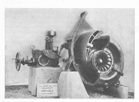
Fig. 7. — Ensemble d'une turbine-tourbillon à réaction avec son régulateur. Usine de Ticapampa (Pérou). 130 chevaux, sous 15 m. de chute, 475 tours par minute,
