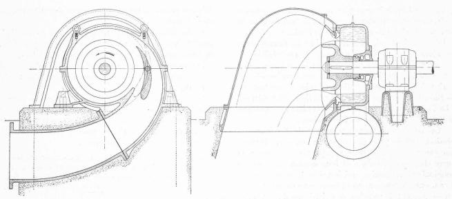
Fig. 4. — Dessin d'exécution d'une turbine-tourbillon à action.
