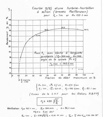
Fig. 5. — Rendement d'une turbine-tourbillon à action.
