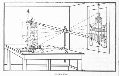
Plan. Fig. 1. — Principe du perspecteur à cardan.
