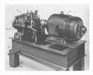
Fig. 6. — Commande auxiliaire du treuil de la station de Weissfluhjoch. (Le moteur auxiliaire transmet son couple à l'arbre du treuil au moyen d'un engrenage réducteur particulier.)
