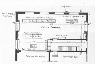
Fig. 41. — Disposition de la salle des tableaux.
