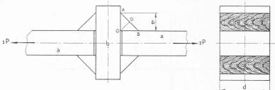
Fig. 5. — Assemblage soudé sans recouvrement.
