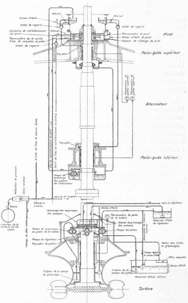
Fig. 37. — Schéma de graissage d'un groupe électrogène.
