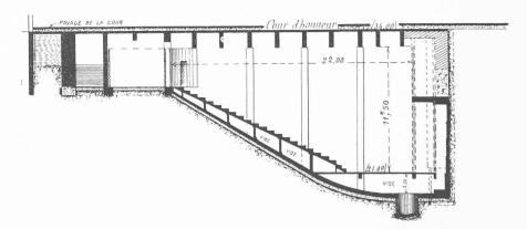
Fig. 3. — Coupe longitudinale sur l'amphitéâtre central, les cloisons en briques sur colonnes supposées non construites.
