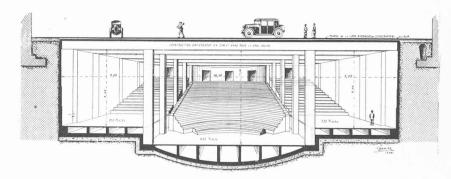
Fig. 6. — Vue perspective des 3 amphithéâtres. Gros œuvre en ciment armé. Cloisons en briques séparant les amphithéâtres supposées non construites. D'après une aquarelle de M. J. Lormier.
