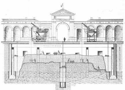
Fig. 5. — Coupe transversale, côté rue St-Martin, montrant la méthode d'exécution des amphithéâtres.
