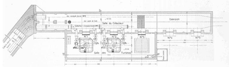
Fig. 32. — Coupe horizontale de l'usine d'Orsières au niveau des turbines. — Echelle 1 : 300.
