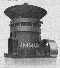
Nouveau broyeur giratoire pour fabrication de sable et gravier.
