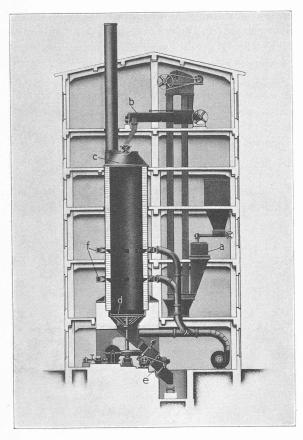
$\begin{array}{cccc} & \text{Fig. 3.} & \text{— Four droit Krupp-Andreas.} \\ \textit{L\'egen\'e.} & -a = \text{bascules automatiques} \; ; \; b = \text{malaxeur} \; ; \; c = \text{distributeur} \; ; \\ d = \text{grille} \; ; \; e = \text{\'ecluse} \; ; \; f = \text{couronnes de tuy\`eres.} \end{array}$
