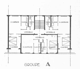
Fig. 2. — Plans du rez-de-chaussée et des étages. Nombre de logements: 66. — Type de logements: 2 ½ pièces. Surface des logements: 43 m². — Cube de construction: 11136 m³. Prix au m³: Fr. 43,44.
