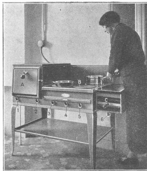
Fig. 3. — Type des cuisinières électriques desservant l'immeuble d'Issy-les-Moulineaux.
