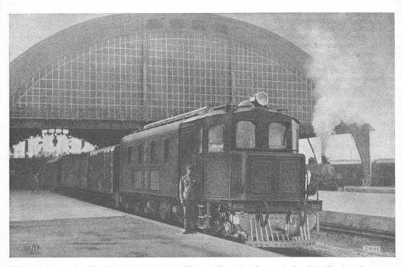
Fig. 2. — Locomotive Diesel des Chemins de fer de l'Etat de Siam, dans la gare de Bangkok (Siam), actionnée par un moteur Diesel-Sulzer à 8 cylindres, de 450 ch à 700 t/mn. Poids en ordre de marche 60 t; vitesse maximum 60 km/h; effort de traction unihoraire 4150 kg.
