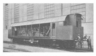
Fig. 1. — Locomotive Diesel-Sulzer de 1000 chevaux, construite en 1912.
