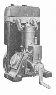
de l'embiellage ; large porte de visite pour le contrôle interne. Soupape d'aspiration fixée directement sur le carter et munie d'un filtre d'air s'enlevant facilement pour le nettoyage.
